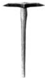
Le pic ou pic à caillou ou marteau à veine
