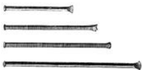
Le fleuret appelé aussi batte ou pince plate. Permet de creuser les trous de mine. Le mineur frappe à l'aide d'une masse sur la tête de l'outil pour creuser peu à peu le trou.
